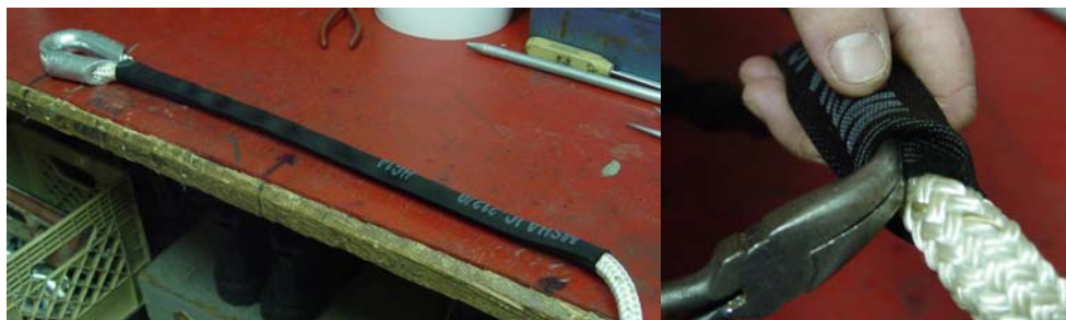
Figure 5 Manche de protection contre le ragage
