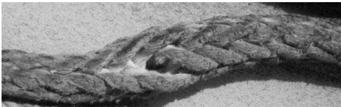
Figure 13 Abrasion entre les torons (l'âme interne exposée révèle de l'usure)
