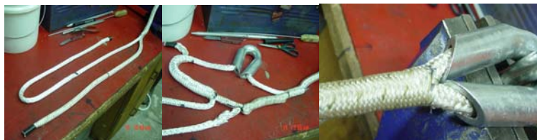
Figure 4 Procédé abrégé d'épissage
