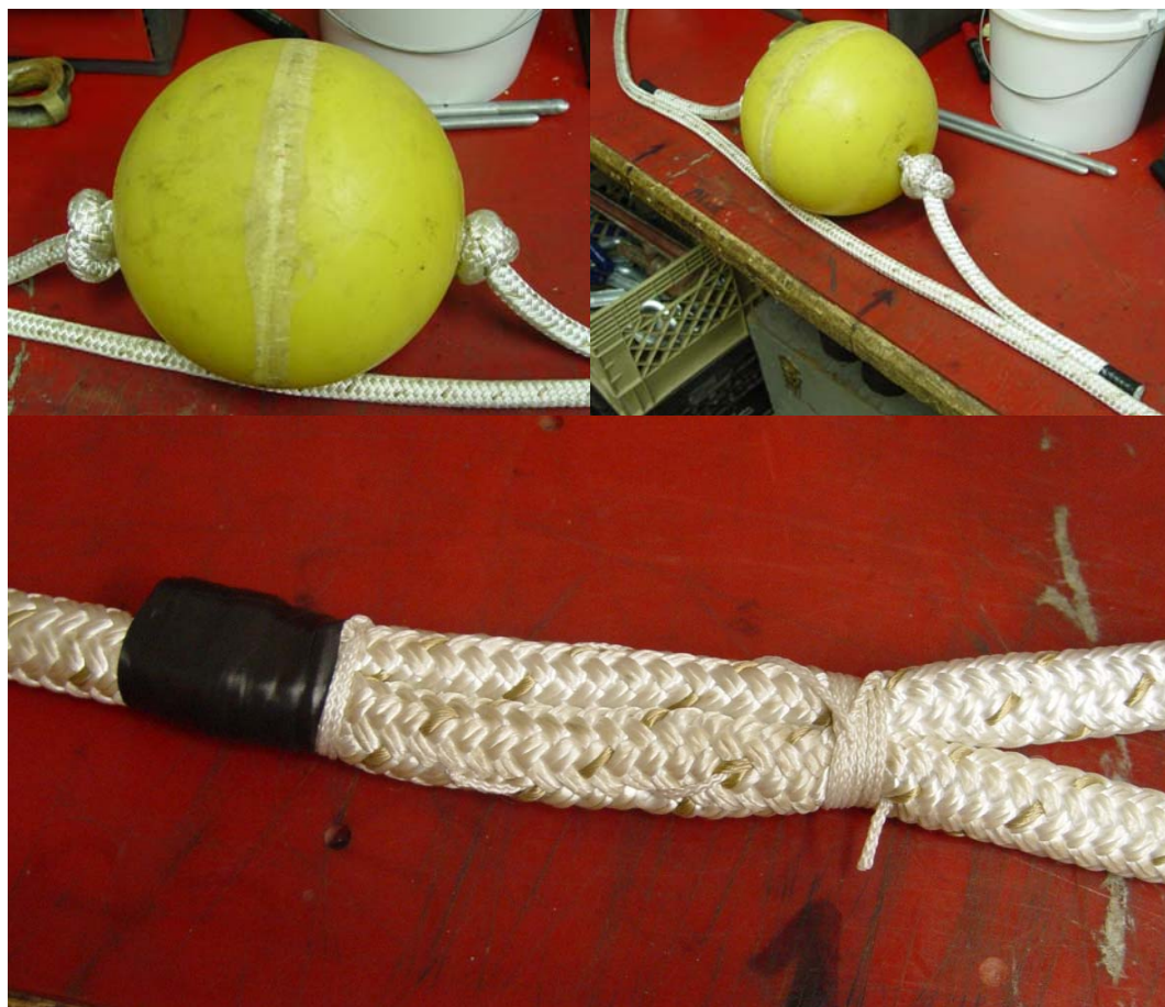
Figure 7 Fixation du flotteur
