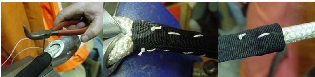
Figure 6 Couture de la manche de protection contre le ragage
